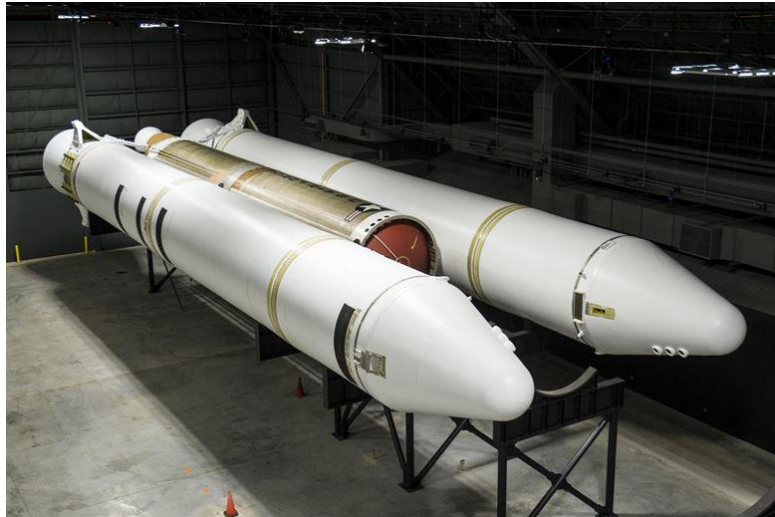
Figure 22 - Premier Etage de Titan IV avec ses deux propulseurs d'appoint
