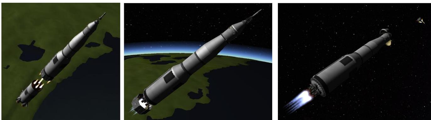
Séparation du S-IC, séparation de la structure inter étage et éjection de la tour de sauvetage
