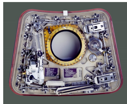
Figure 9 - L'écoutille du CM d'Apollo 11
