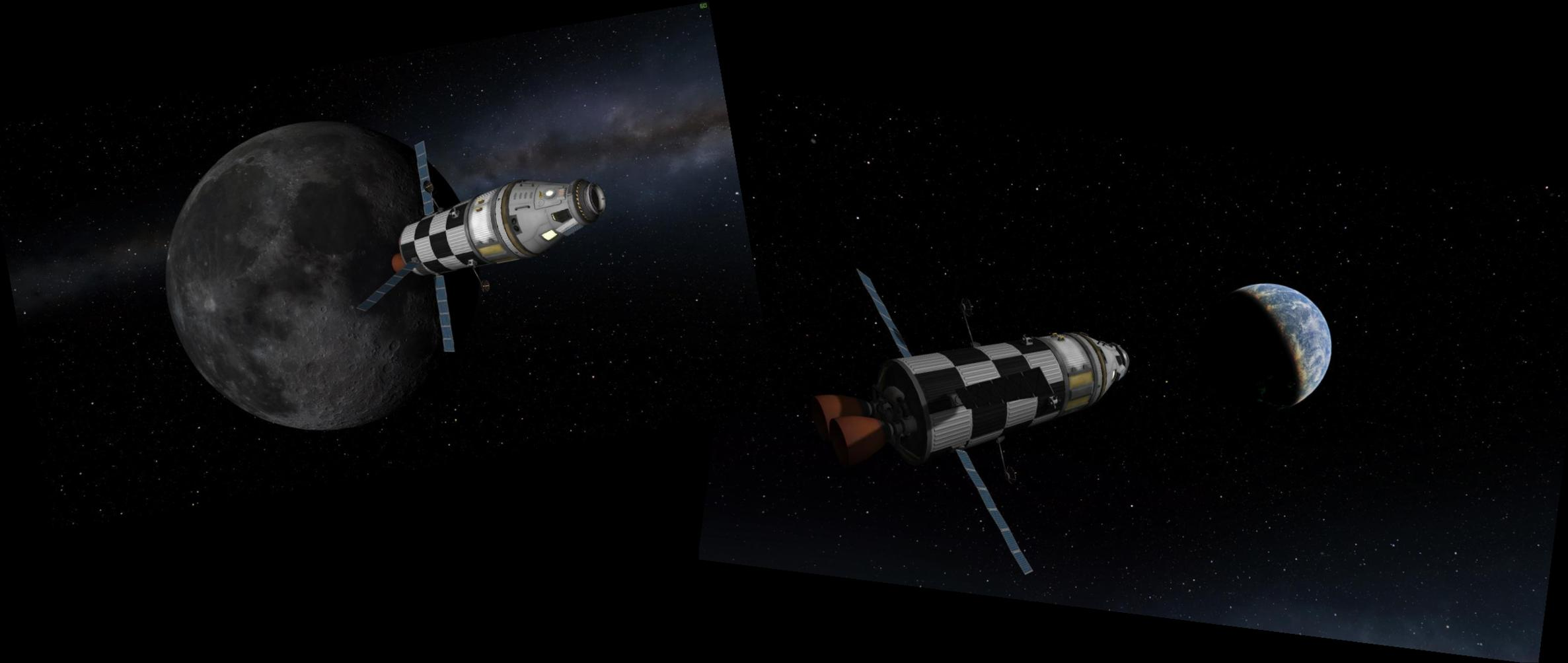
Quelques minutes avant la réentrée atmosphérique, le module de service de Kolumbia est largué, exposant à l'espace le bouclier thermique du module de commande. Il est ensuite orienté face au prograde.
