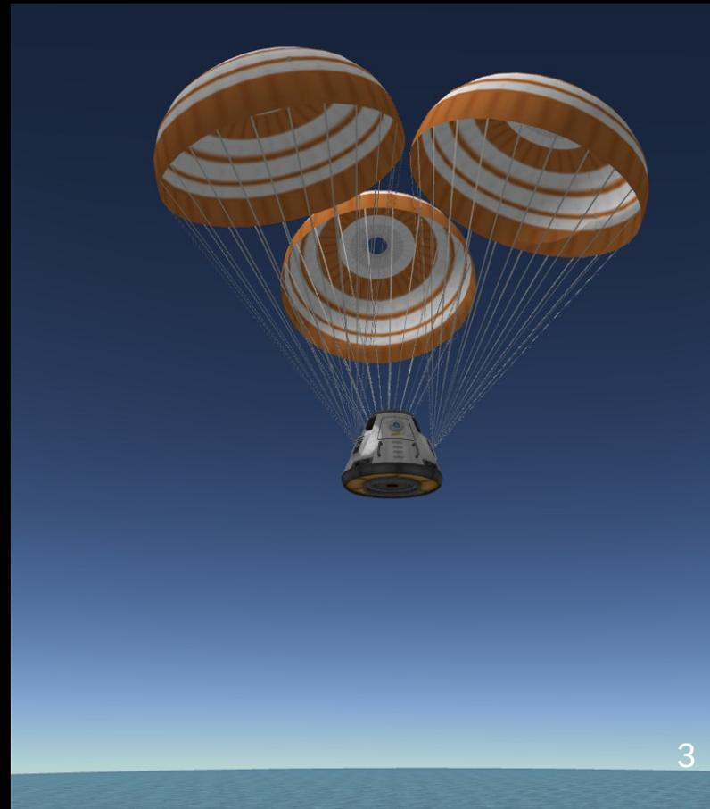
*Sur les 3 000 t de la Saturn V au décollage seules les 6 t du module de commande reviennent sur Terre. L'ouverture de parachutes permet un atterrissage en douceur.*
