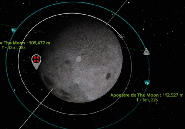
*La capture de la Lune se fait en deux temps : une première orbite elliptique de 110x315 km puis une orbite circulaire de 109x112 km. (Objectif 4 validé)*
