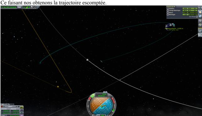
Pour minimiser la masse de la sonde et améliorer le freinage en améliorant le ratio « masse/surface de freinage » les aérofreins sont déployés et le compartiment moteur est largué une fois cette trajectoire obtenue. Le seul réservoir RCS étant dans le compartiment moteur notre sonde se retrouve sans moyen de propulsion ne pouvant s'orienter que grâce aux roues de réaction.
