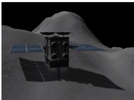
T+1a151j0h352m14s : Rallumage des moteurs ioniques, Départ Ryugu. Les propulseurs à hydrazine fonctionnent jusqu'à ne conserver qu'un sixième de leur carburant pour alléger la sonde et les propulseurs ioniques font le reste (cout approximatif : 220m/s)
