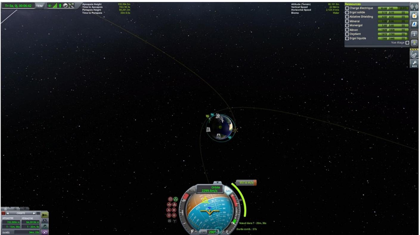
Choix d'une orbite de parking d'environ 84\*130km, orbite qui ne sera pas même pas complétée après un un rallumage du second étage pour un burn d'injection en orbite héliocentrique
