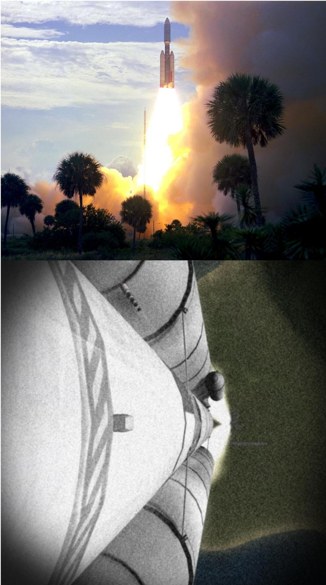
4- Allumage de l'étage 2 quelques secondes avant l'extinction des boosters (l'axe des moteurs passe par le centre de gravité au cas où un moteur tomberait en panne)
